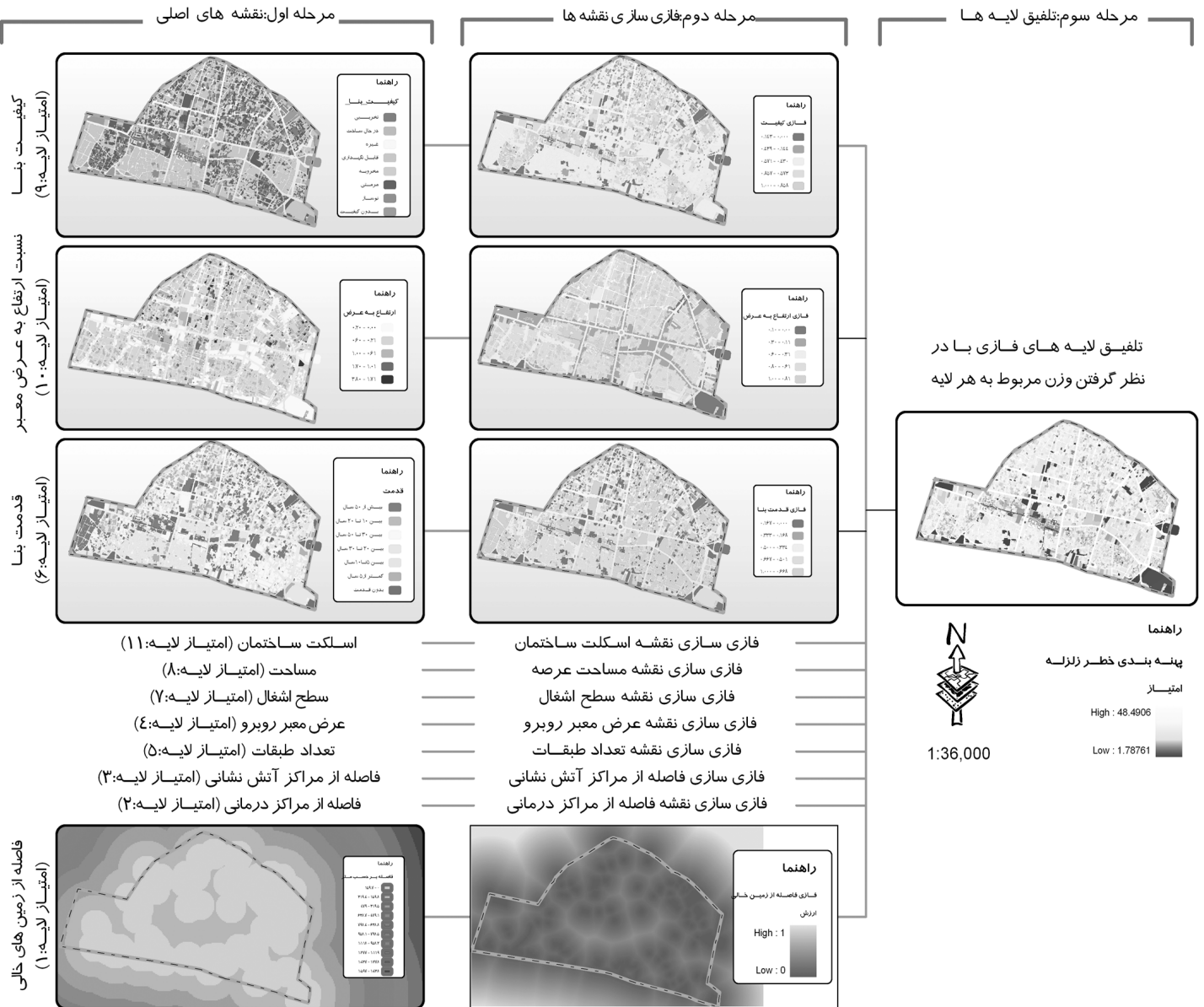
تصویر ۲- مراحل مدل سازی تعیین عوامل سازه‌ای/ساختمانی موثر بر آسیب‌پذیری ناشی از زلزله.
